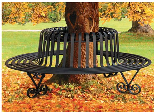
**PANCHINA DECORATIVA** • Piano di seduta costruito con profili li ovali zincati di sezione mm. 40x20x1,5. Montanti realizzati in ferro piatto zincato sagomato di sezione mm. 35x4.
