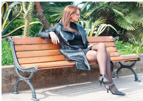
**PANCHINA "AGORA"** • Realizzata con dieci doghe in legno di IROKO o in Pino Silvestre di sezione mm. 58x40 ed inserite ad incastro nella struttura portante e bloccate con tre tiranti M14. Montanti di forma anatomica realizzati in ghisa "G25-UN15007" lamellare lavorata.
