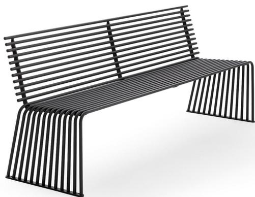
**.015 PANCA CON SCHIENALE** - Un ampio schienale unisce una confortevole permanenza al piacere di fruire di un oggetto unico. Struttura in tubi calandrati di diametro 18 mm, in acciaio inox o acciaio verniciato con polveri epossidiche in diversi colori. La struttura in metallo per uso esterno viene sottoposta a trattamento di zincatura a caldo. Predisposta per il fissaggio a terra con tasselli o per l'aggancio multiplo con piastra in acciaio.
