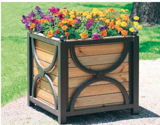
**FIORIERA "IRIS"** • Struttura perimetrale realizzata con quattro tubolari verticali di sez. mm. 50x50x2, completi di sfera decorativa superiore. Decorazioni interne realizzate in tubo centinato a freddo di sezione ovale mm. 40x20x2. Fioriera interna in legno.
