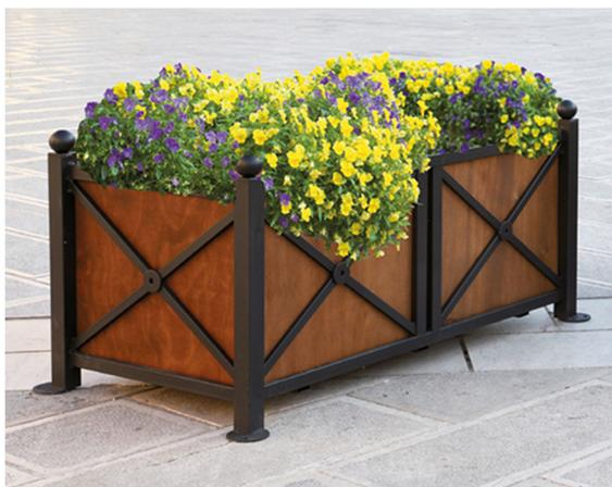
**FIORIERA "DORIS"** • Struttura perimetrale realizzata con quattro tubolari verticali di sez. mm. 40x40x2, completi di sfera decorativa superiore. Decorazioni interne realizzate in tubo di sez. mm. 30x15x2 e mm. 20x10x2. Rivestimento interno pareti laterali in multistrato marino Okumè mordenzato color noce. Contenitore interno per terriccio in PVC.
