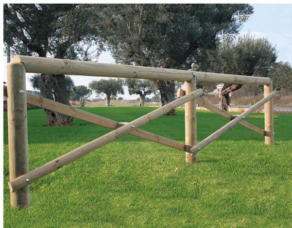
**STACCIONATA "A CROCE S. ANDREA"** • Ogni modulo è composto da: Un montante fresato in testa del diametro di cm 12x133 h. Un correntino superiore con palo tondo di diametro cm. 12x200 (passo). Due traversi con palo tondo di diametro cm. 8x230 + distanziatore centrale. Una staffa zincata ad "U".
