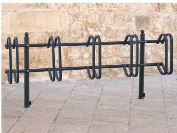
**PORTABICICLETTE "TORINO" VERTICALE** • Struttura portante in tubo acciaio tondo Ø mm. 40x2. Ferra ruota in tubo acciaio tondo di diametro mm. 30 • Due supporti verticali in tubo tondo Ø mm. 60 completi di sfere decorative superiori. Zincato e verniciato
