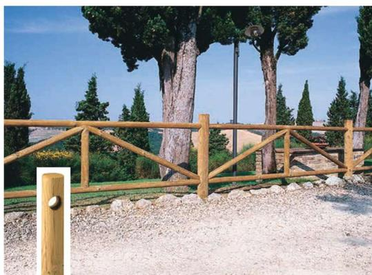
**STACCIONATA "MERANO"** • Ogni modulo è composto da: Un montante diametro cm 14x133 h (con due fori da cm. 8,5 ad interasse di cm 80). Due correntini (uno superiore e uno inferiore) con palo tondo di diametro cm. 8x300 (passo). Un tramezzo verticale con palo tondo di diametro cm. 8x80. Due traversi inclinati con palo tondo di diametro cm. 8x170.
