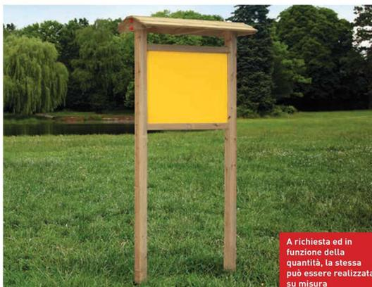
**BACHECA "LIVIGNO"** • 2 montanti laterali in lamellare sez. cm 9x9. Tetto superiore a doppia falda realizzato con tavole impregnate ad incastro spessore cm 2. Pannello centrale realizzato in multistrato marino Okumè verniciato mm 1 O supportato in orizzontale da morali di sez. cm. 7x7.
