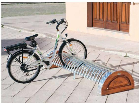
**PORTABICICLETTE "SFERICO"** • Due supporti laterali realizzati in legno di pino impregnato lamellare sagomati al pantografo (dim. cm 70x9x40h), completi nella parte superiore di lamiera decorativa antiscivolo in alluminio. Telaio portabicicli in tubo tondo Ø mm. 40x2 di spessore, con elementi di parcheggio in tubo tondo Ø mm. 25x2, completamente zincato a caldo.
