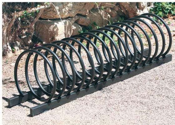
**PORTA BICICLETTE "TORINO"** • Struttura portante in tubo acciaio tondo di diametro mm. 40x2. Ferra ruota in tubo acciaio tondo di Ø mm. 30. Completamente zincato a caldo, munito di predisposizione per l'ancoraggio al suolo e di tappi in PVC inestraiibili alle estremità.
