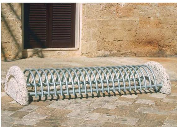
**PORTABICICLETTE MULTIPLO** • Supporti in cemento armato vibrato e trattato con idrorepellente con telaio centrale in tubo tondo di acciaio di Ø mm. 40 e con elementi di parcheggio in tubo tondo di acciaio diametro mm 25. Completamente zincato a caldo.
