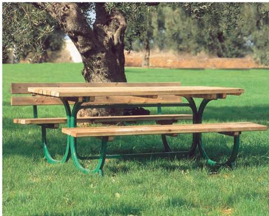
**COMPLETO PIC-NIC** • Struttura portante in tubo di acciaio curvato a freddo di sezione semiovale mm 60x30x2, composto da due panche fissate (con due doghe di sezione mm 115x45 e da una dogha di sezione mm 95x45) e un tavolo centrale (con otto doghe di sezione mm 95x45) realizzate in legno di Pino Silvestre; completo di piastre per l'ancoraggio al suolo.
