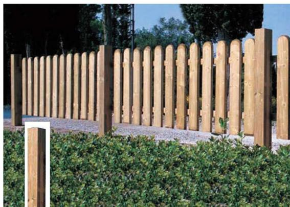
**STACCIONATA "BOLZANO"** • Ogni modulo è composto da: Un montante verticale di sezione cm. 6x9x130h. Dodici tavolette verticali smussate in testa di sezione cm. 1,8x9.
