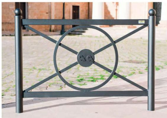
**ARCHETTO PARAPEDONALE MODULARE** • Due montanti laterali realizzati in tubo acciaio tondo Ø mm. 80×3 completi di "cappellotto" superiore lievemente bombato e piastra forata Ø mm. 100×4 per il fissaggio al suolo. Struttura interna realizzata in tubo quadro sez. mm. 30×30×2 curvato a freddo e decorazioni interne in tubo sezione ovale mm. 40×20.
