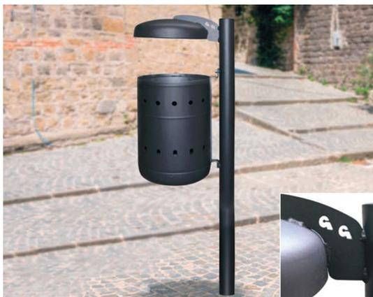
**CESTINO "CATANIA" CON COPERCHIO** • Cestello cilindrico a fondo bombato di Ø cm. 30x48h in lamiera acciaio zincata dello spessore di 10/10, con doppia fi la decorativa di fori tondi ed asolati. Sistema di sganciamento a ribalta con chiavino a brucola in dotazione. Paletto di sostegno in tubo acciaio tondo diametro mm. 60x2.
