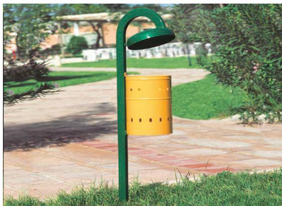
**CESTINO "TAORMINA"** • Munito di paletto da interrare, in tubo tondo di acciaio Ø mm. 60x2. Cestello cilindrico a fondo bombato di Ø cm. 30x48h in lamiera di acciaio zincato bordata e calandrata. Rivestito con doghe in legno di pino. Sistema di sganciamento a ribalta con chiavino a brucola in dotazione
