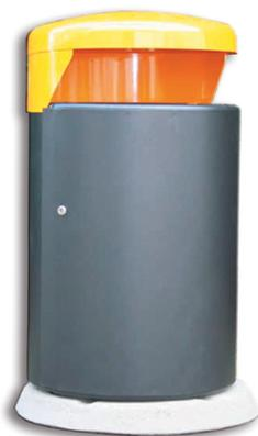
**CESTONE CITY** • Realizzato in lamiera di acciaio spessore 10/10 con struttura di irrigidimento in tubo tondo diametro mm. 25x1,5. Coperchio in lamiera di acciaio bombata spessore 15/10. Base d'appoggio in CLS sabbato trattato con idrorepellente antidegrado. Contenitore interno in PVC, sfi labile per la raccolta rifi uti (in dotazione).
