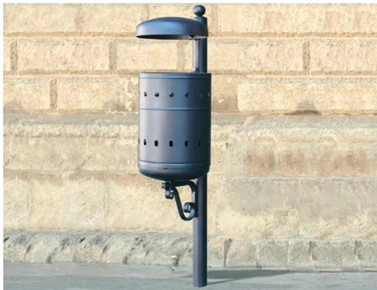
**CESTINO "CENTRO STORICO" CON COPERCHIO** • Munito di paletto, da interrare, in tubo acciaio tondo Ø mm 60x2, con sfera in ghisa nella parte superiore e sostegno sagomato reggi cestello. Coperchio superiore in lamiera d'acciaio bombata. Cestello cilindrico a fondo bombato di Ø cm. 30x48 h in lamiera acciaio zincata con doppia fi la decorativa di fori tondi ed asolati. Sistema di sganciamento a ribalta con chiavino a brucola in dotazione.
