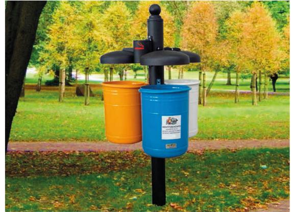
**CESTINO "CATANIA"** • Cestello cilindrico a fondo bombato di diametro cm 30x48h in lamiera acciaio zincata dello spessore di 10/10, con doppia fi la decorativa di fori tondi ed asolati. Sistema di sganciamento a ribalta con chiavino a brucola in dotazione. Paletto di sostegno in tubo acciaio tondo diametro mm 60x2.
