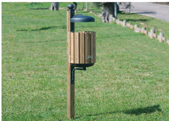
**CESTINO "CUNEO" RIVESTITO IN LEGNO** • metallica decorativa superiore e coperchio in acciaio bombato. Cestello cilindrico a fondo bombato di diametro cm. 30x48 in lamiera acciaio zincato spessore 10/10, rivestito con doghe in legno di pino impregnato. Sistema di sganciamento a ribalta con chiavino in dotazione.
